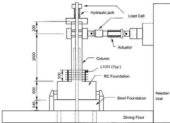
Fig. 6—Test setup (unit:mm).
