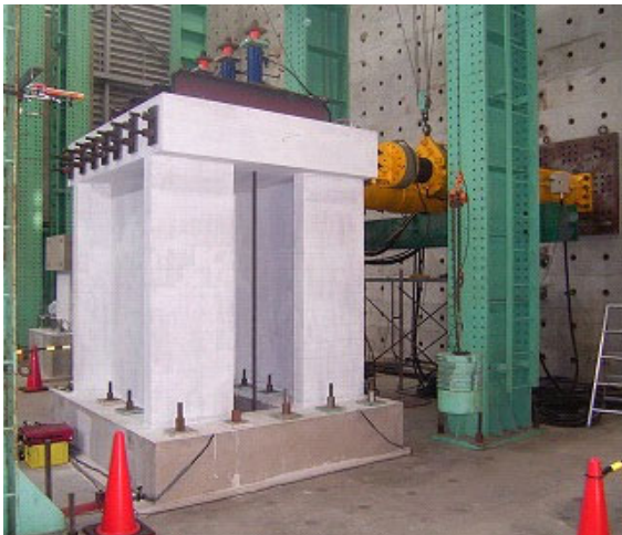
写真-4 載荷実験装置による加力状況
