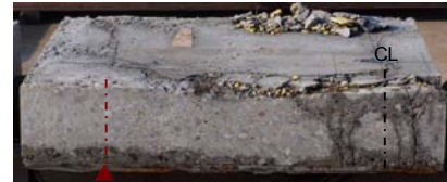
(a) リブ C+50mm 位置切断面
