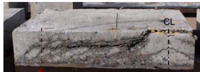
(a) リブ C+50mm 位置切断面
