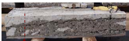
(b) リブ D+50mm 位置切断面
