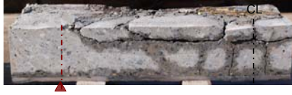
(b) リブ D+50mm 位置切断面
