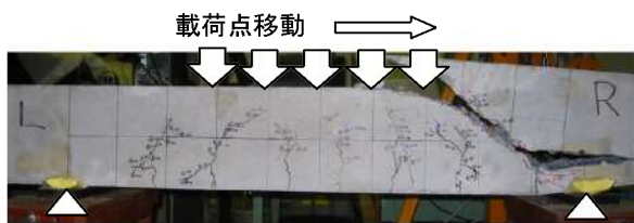
写真-9 破壊時ひび割れ (ケース 8)
