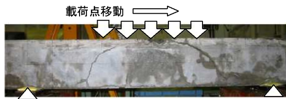
写真-11 破壊時ひび割れ (ケース 10)
