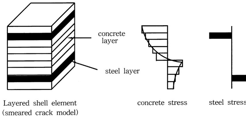
Fig. 12. Layered shell element.
