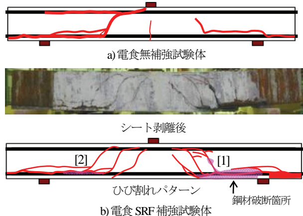
図-10 電食無補強試験体・電食予防保全的な補強試験体ひび割れ状況比較
