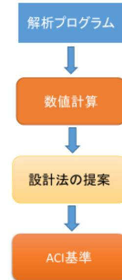
DR. Breen の作成したプログラムを用い、実験の代替としての数値計算結果を用いる研究に従事しました。鉄筋コンクリートラーメンに作用する曲げモーメントは、部材剛性の影響を受けますが、設計では、一般に弾性解析によって、モーメントの分配を決めています。
