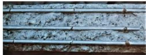
コンクリートは内部の鉄筋が腐食するのを防止する機能があります。しかし、持続荷重によって発生するひび割れの幅が過大となると、その機能が損なわれ、許容される引張応力度が制限を受けます。
