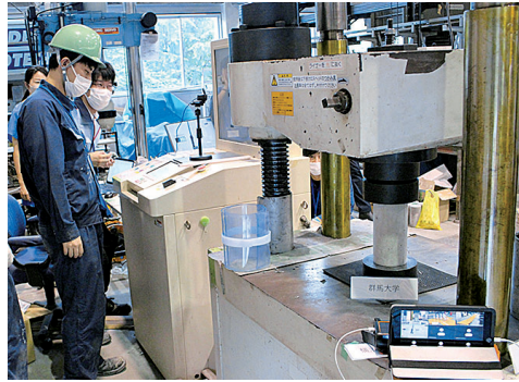
試験体の圧縮強度試験
